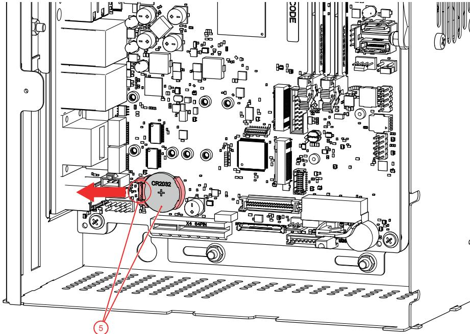
6. Setzen Sie die neue Batterie an der Feder an und drücken die Batterie in die Halterung. Um die Laufzeit zu verlängern, verwenden Sie Batterien vom Typ CR2032 von Markenherstellern.
